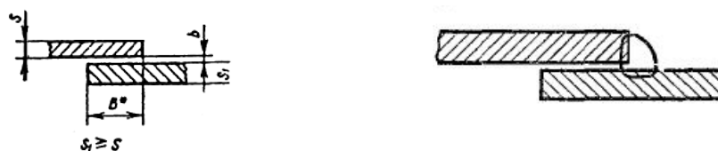
Рисунок 1.6 – Соединение Н1 - Δ3 по ГОСТ 14771-76, сварной шов №2
