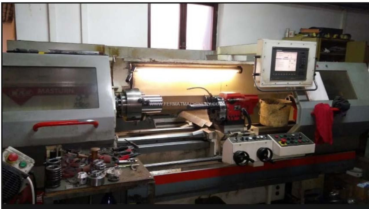
Рисунок 3- Станок токарный с программным управлением модели MASTURN 54
