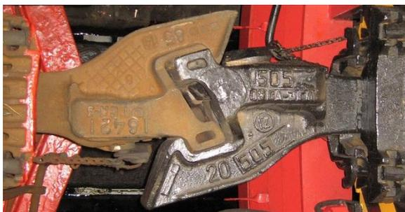
Рисунок 1 – Автосцепка вагона
