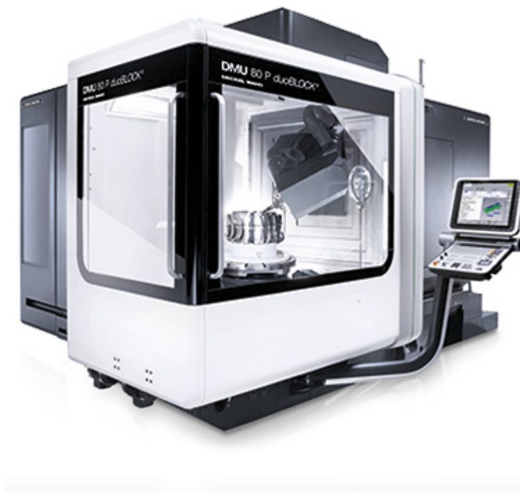
Рисунок 3 – Общий вид универсального обрабатывающего центра с ЧПУ DMU 80P.
