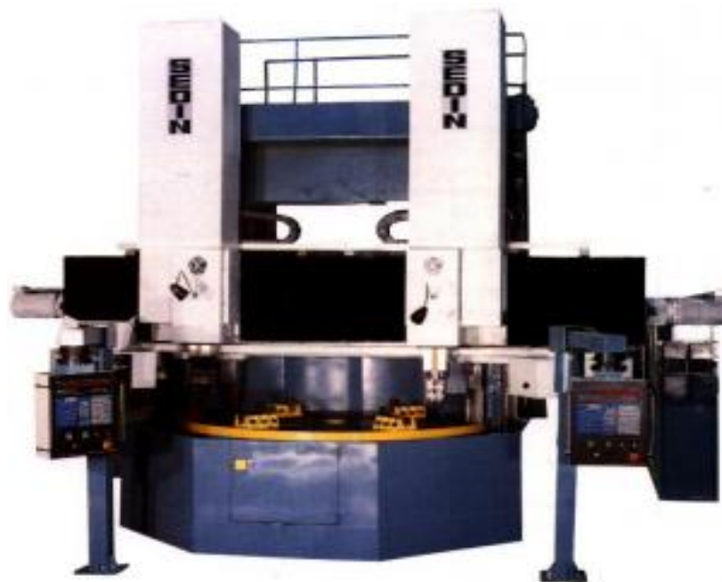
Рисунок 8 – Токарно-карусельный станок с ЧПУ 1А525МФ3
