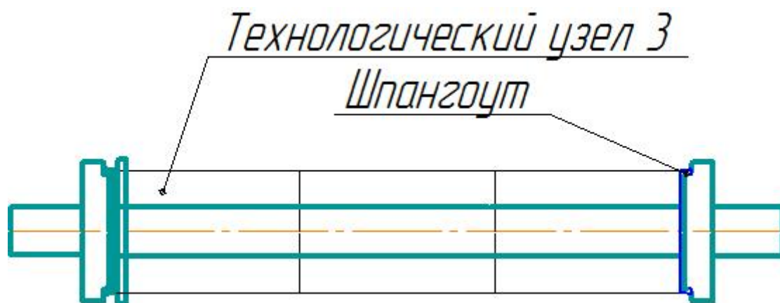
Рисунок 44 – Переналадка оправки для приварки второго шпангоута к технологическому узлу №3
