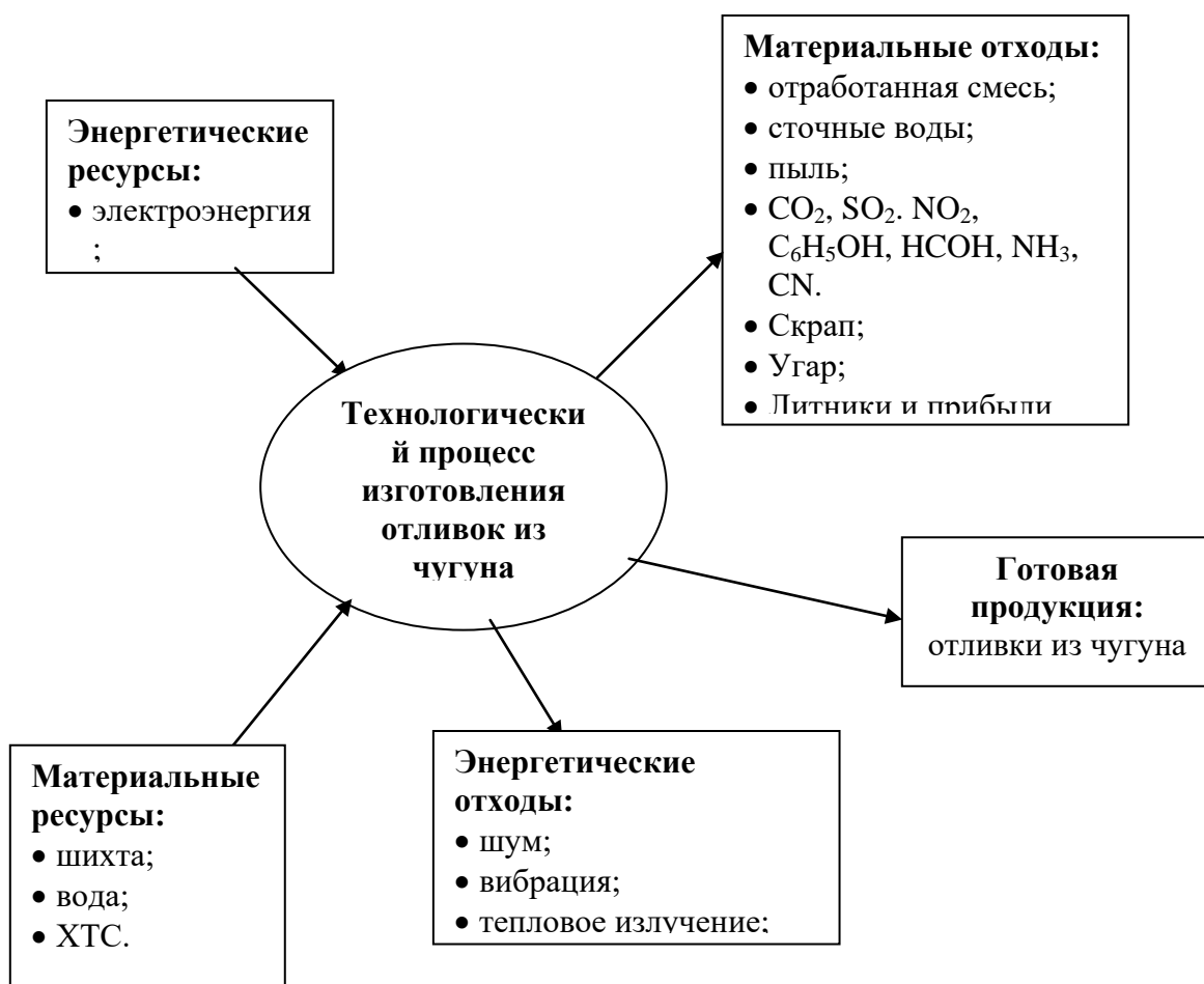
Рисунок 2 – Схема технологического процесса изготовления отливок
