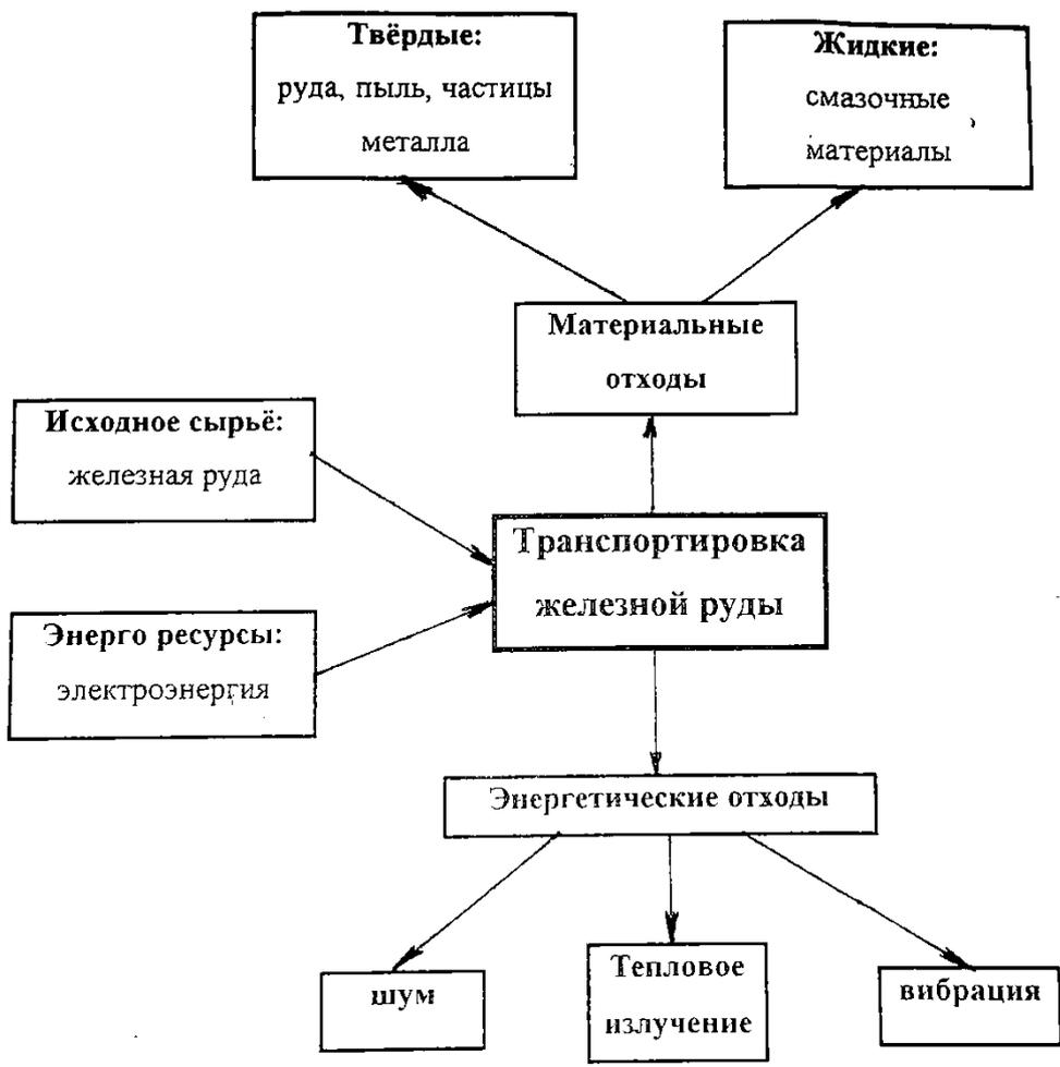
Рисунок 16 – Схема технологического процесса транспортировки железной руды
