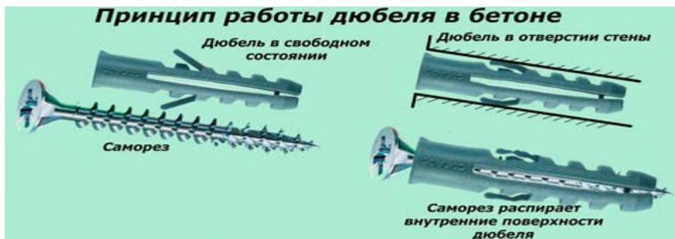
Рисунок 14 – Разворачивание дюбеля в стене
