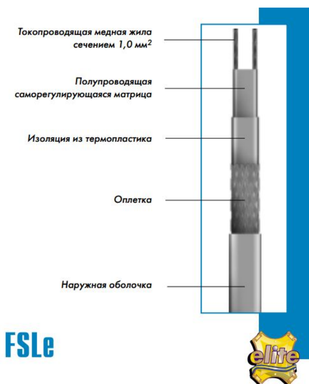
Рисунок Г.2 – Элементы саморегулирующего кабеля 23FSLe
