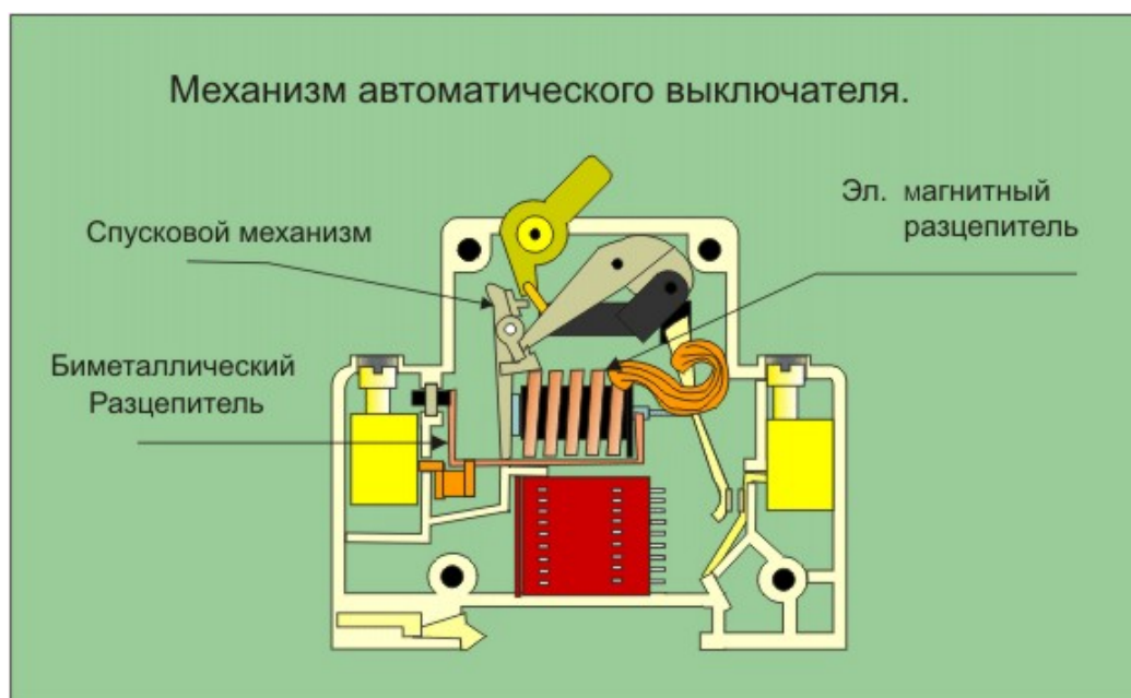
Рисунок 4 – Устройство автоматического выключателя
