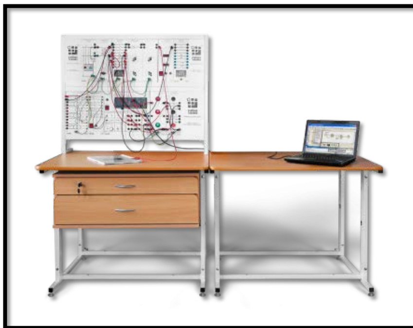
Рисунок 3 – Внешний вид стенда «Релейная защита и автоматика в системах электроснабжения»
