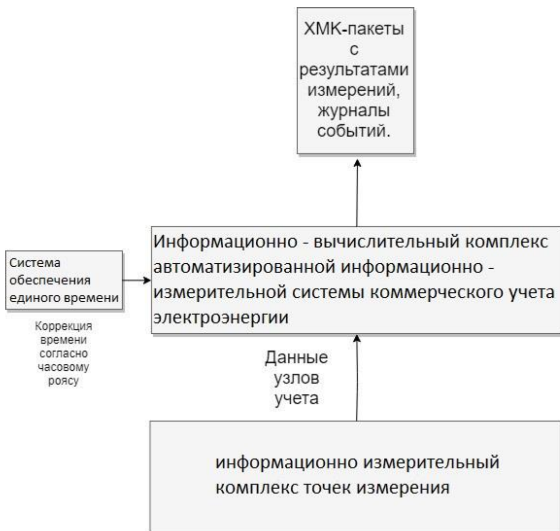
Рисунок 2 – Функциональная структура автоматизированной информационно-измерительной системы коммерческого учета электроэнергии
