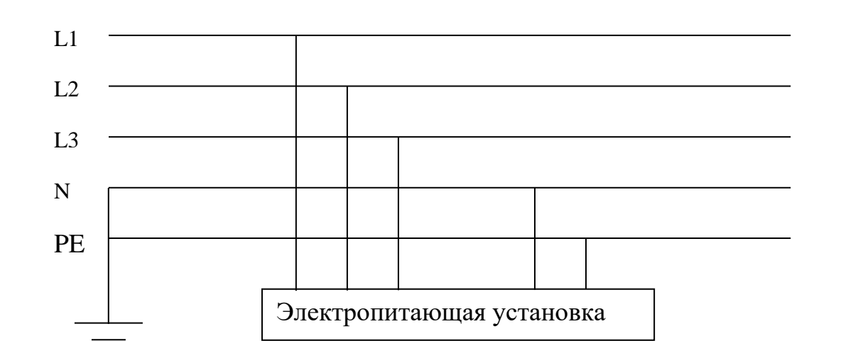
Рисунок 11 – Система заземления TN-S
