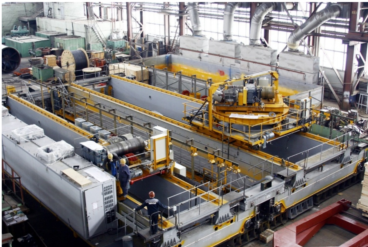
Рисунок 3 – Кран кругового действия для реакторных залов АЭС Куданкулам
