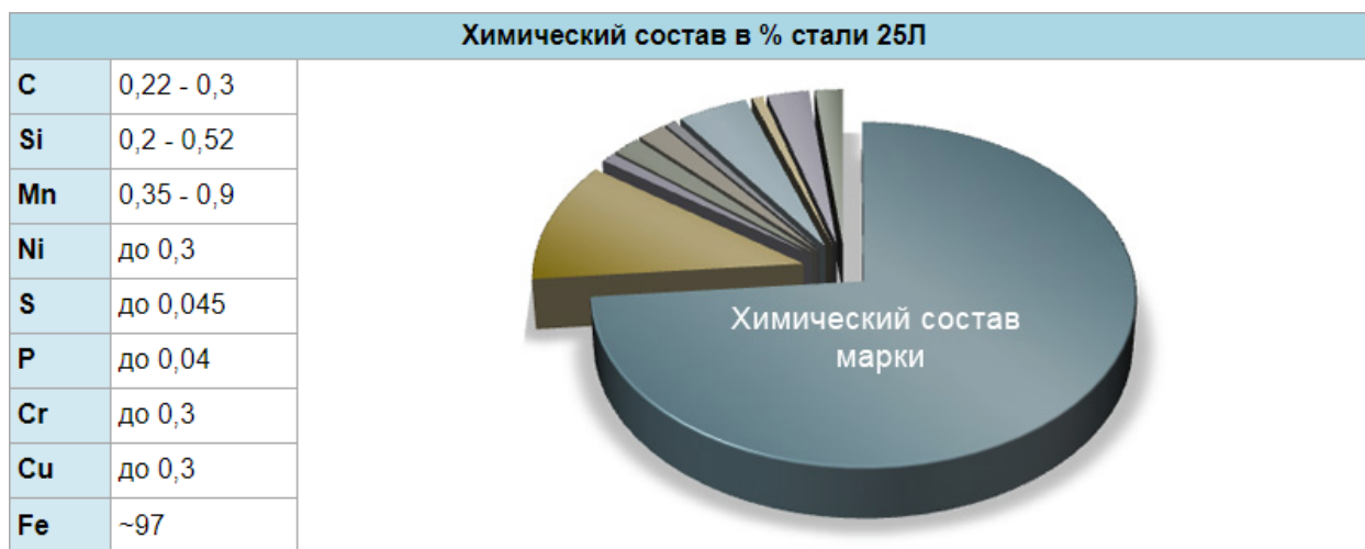
Рисунок 2 – Химический состав стали 25Л
