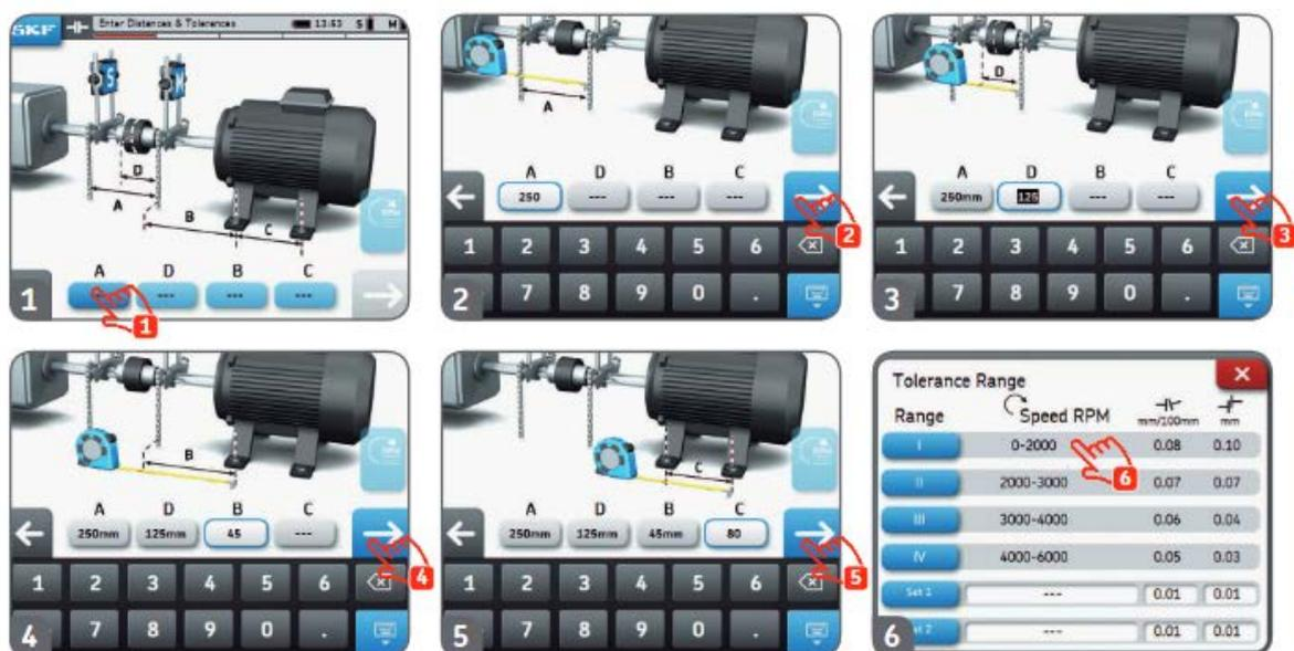
Рисунок 18 - Меню ввода необходимых размеров двигателя и муфты
