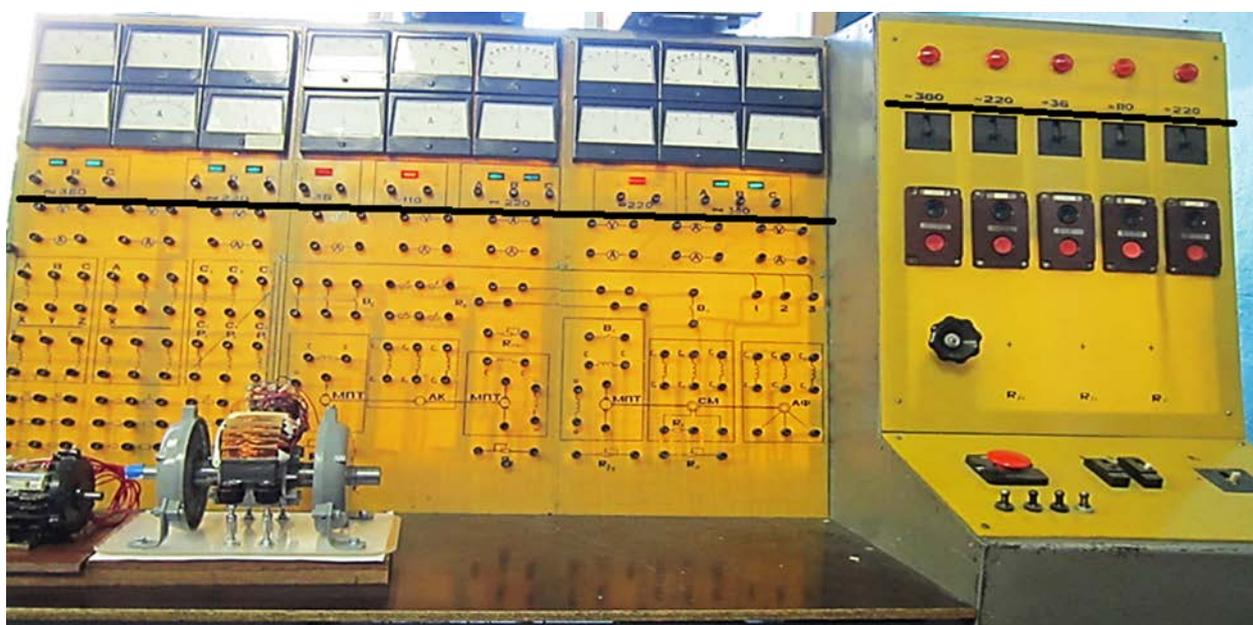
Рисунок 4 – Панель управления учебного лабораторного стенда
