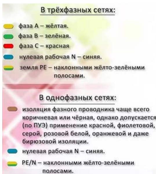
Рисунок 13 – Цветовая маркировка проводов
