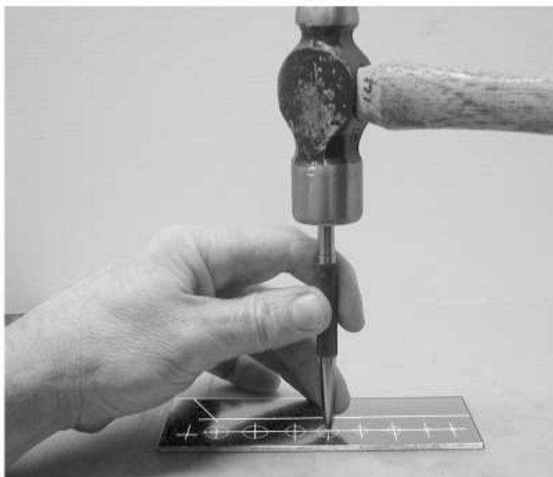
Кернение для последующего сверления.
