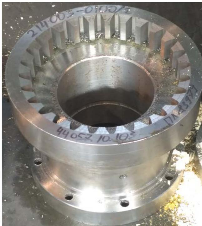
Рисунок 2 – Фотография детали «Ступица для запасного привода буровой установки»
