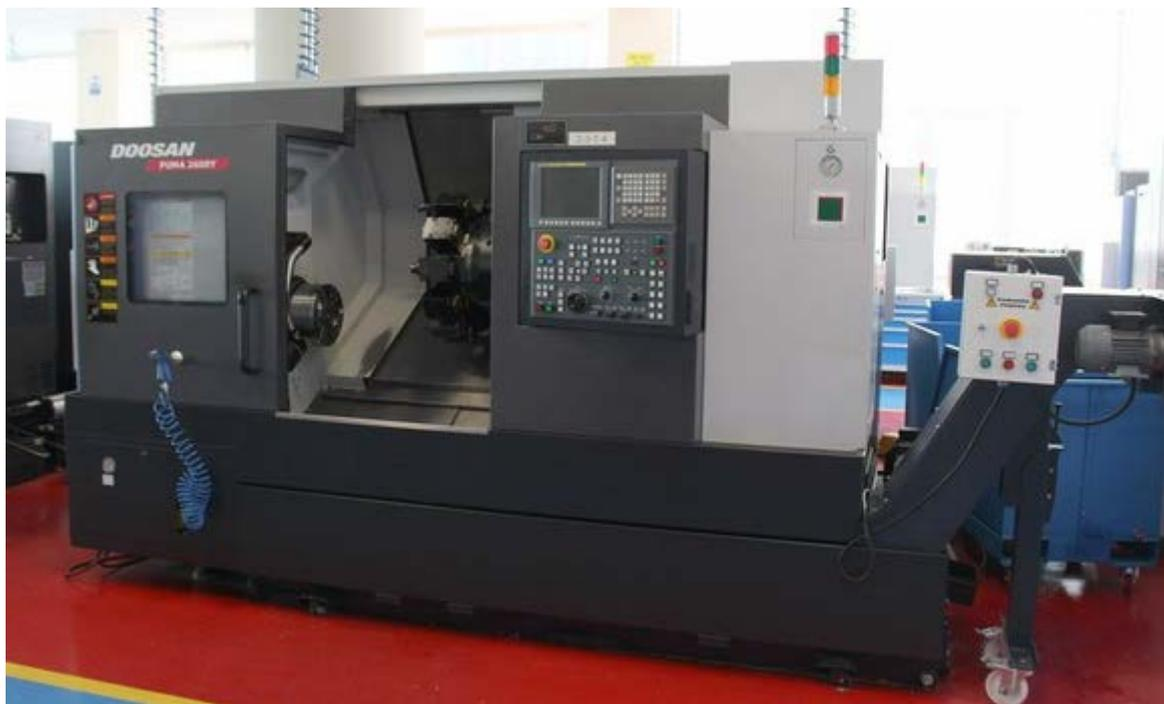
Рисунок 8 - Токарно-фрезерный обрабатывающий центр с ЧПУ DOOSAN PUMA 480M
