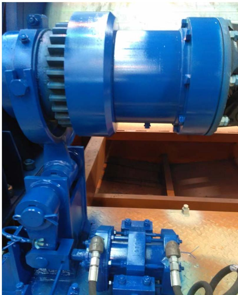
Рисунок 1 – Узел привода лебедки запасного привода буровой установки
