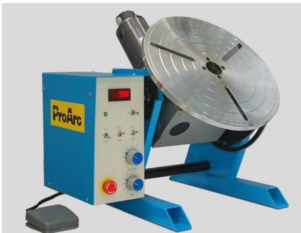
Рисунок 10 – Сварочный вращатель РТ-1500 (ProArc)
