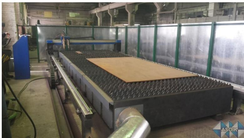
Рисунок 15 – Машина термической резки ASOIK Compact
