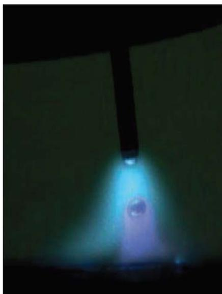
Рисунок 4 – Импульсная дуга
