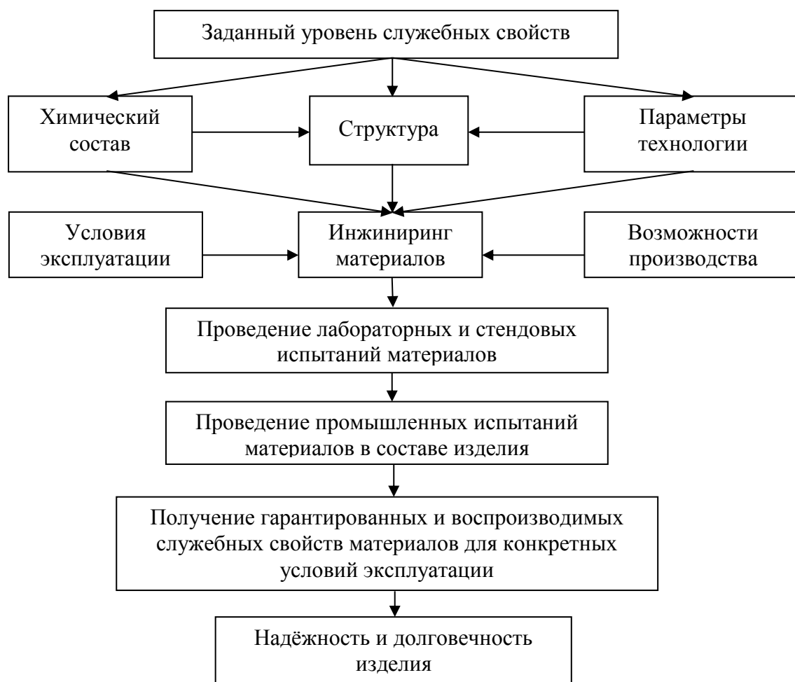
Рисунок 1 – Последовательность оценочных действий для решения материаловедческой задачи по выбору материала и технологии его получения и обработки
