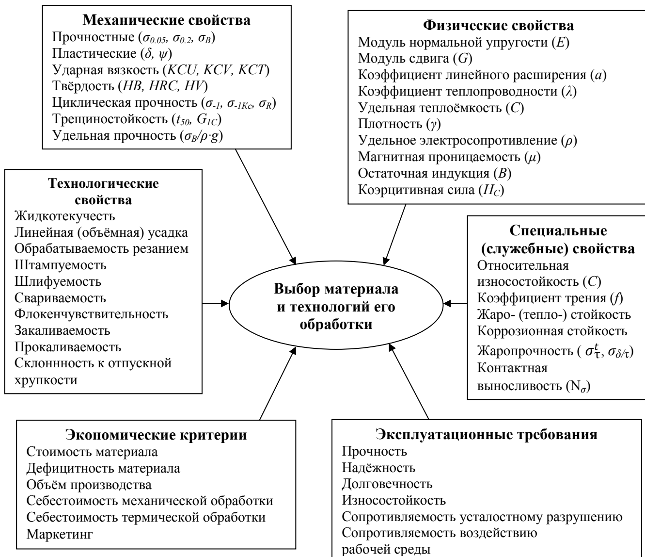
Рисунок 2 – Основные критерии для рационального выбора конструкционного материала в машиностроении
