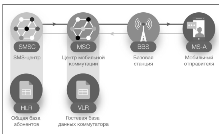
Рисунок 3 — Путь от центра обработки коротких сообщений до получателя
