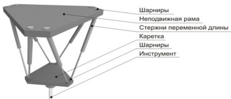
Рисунок 1 - Координатно-измерительная машина Лапик-1200/2100
