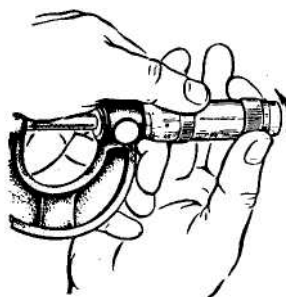
Рисунок 11 - Закрепление барабана микрометра корпусом трещотки
