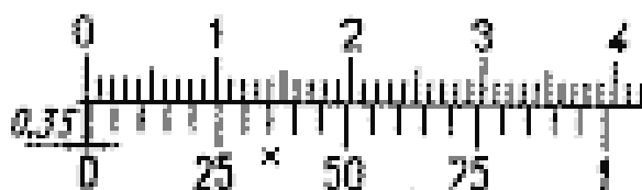
Рисунок 4 - Определение доли миллиметра (крестиком указан 7-ой штрих нониуса)
