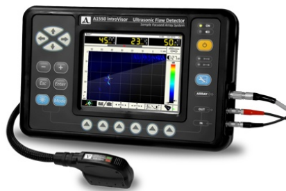
Рисунок 12 – Универсальный ультразвуковой дефектоскоп с цифровой фокусировкой антенной решеткой и томографической обработкой данных для контроля металлов и пластмасс A1550 IntroVisor
