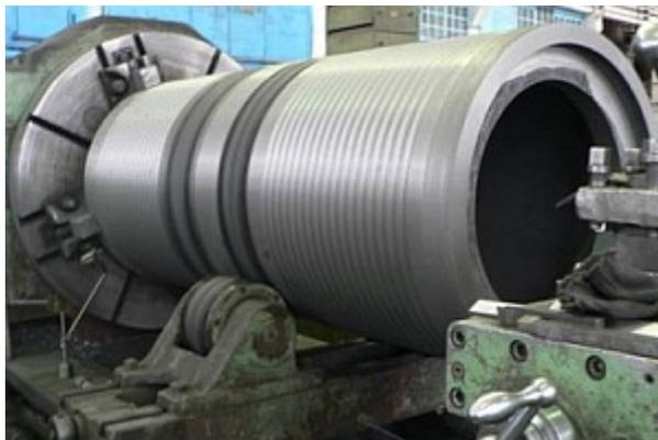
Рисунок 1 - Барабан мостового крана
