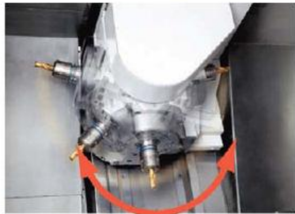
Индексирование оси В: 225° (минимальный заданный угол: 0,001°)
