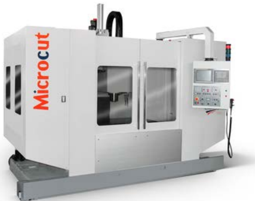
Рисунок 5 – Обрабатывающий центр с ЧПУ модели VM-1000
