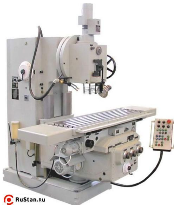
Рисунок 5 – Станок вертикально-фрезерный FSS450MRNC
