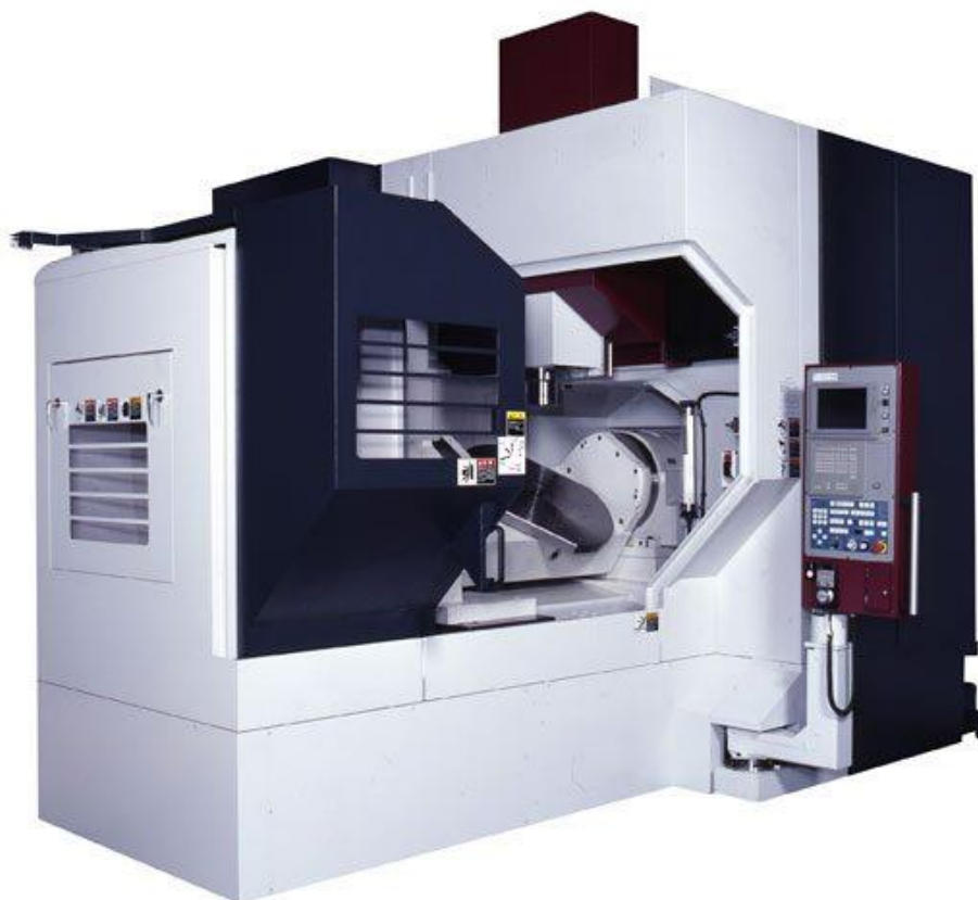
Рисунок 6 – Вертикально фрезерный ОЦ ОКК VP 9000 – 5AX
