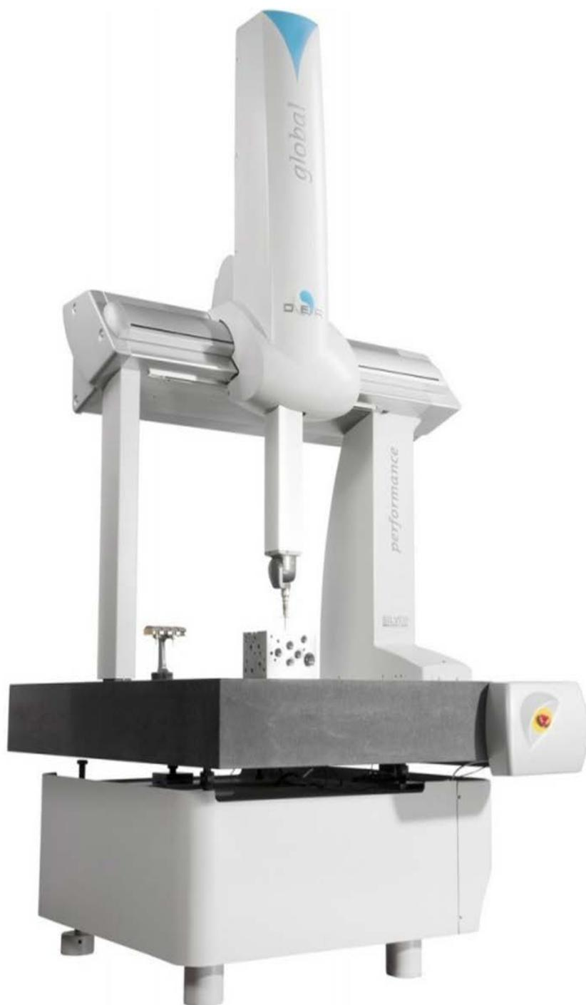
Рисунок 1 – Общий вид машины трехкоординатной измерительной
