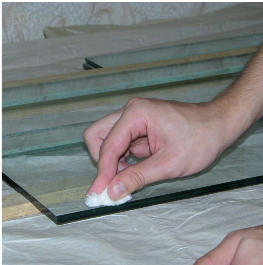
Рис. 1 Очистка стекла от загрязнений
