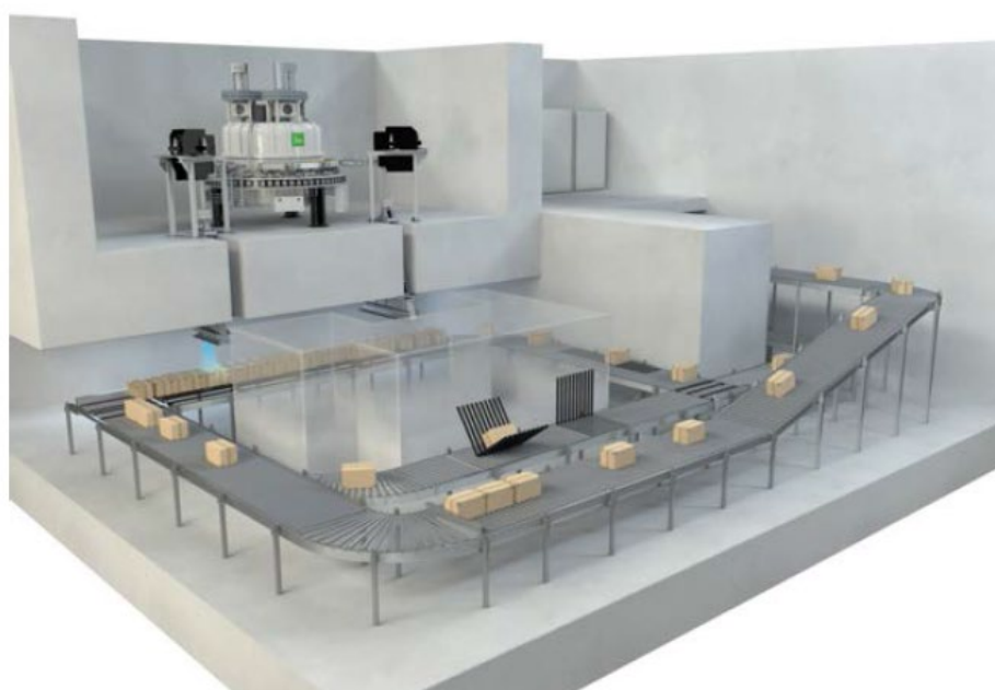
Рисунок 2 — Пример оборудования для радиационной обработки на основе ускорителя электронов [1]
