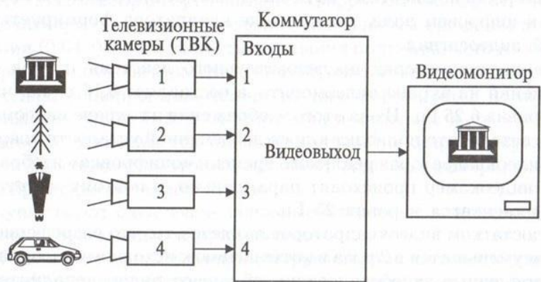
Рисунок 3 Структурная схема видеоконмутатора
