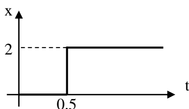
Рис.1.18. Временной график задающего сигнала.
