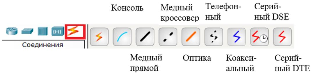
С помощью этих компонентов создаются соединения узлов в единую схему. Packet Tracer поддерживает широкий диапазон сетевых соединений. Каждый тип кабеля может быть соединен лишь с определенными типами интерфейсов.
