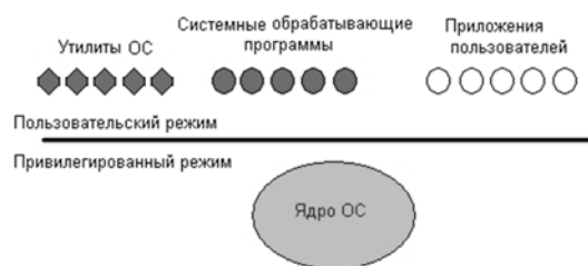
Рисунок 3 – Операционная система с ядром в привилегированном режиме
