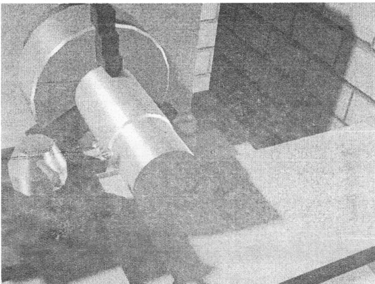
Рис.4. Обточка заготовки на токарном станке
