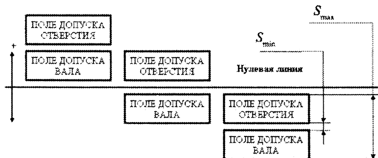
Рис. 4.4. Варианты размещения относительно нулевой линии полей допусков отверстия и вала для посадки с одинаковыми зазорами
