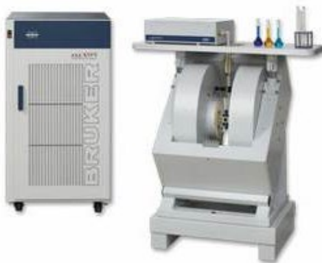
Рис. 2. Внешний вид установки ЭПР – Bruker ELEXSYS E500
