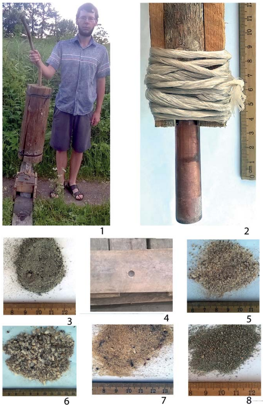
Рис. 1. Экспериментальные приспособления и исходные материалы для сверления. 1 – С.В. Грехов с коловоротом; 2 – крепление сверла (медной трубки) в коловороте; 3 – абразив из гранодиорита; 4 – фиксатор; 5 – абразив из мелкодробленого кварца; 6 – абразив из крупнодробленого кварца; 7 – абразив из мелкозернистого речного песка; 8 – абразив из мелкозернистого наждака Fig. 1. Experimental devices and raw materials for drilling. 1 – S. V. Grekhov with a brace; 2 – fixing of a drill (copper tube) in a brace; 3 – abrasive from granodiorite; 4 – locking device; 5 – abrasive from fine-grained quartz; 6 – abrasive from coarse-grained quartz; 7 – abrasive from fine-grained river sand; 8 – abrasive from fine-grained emery
