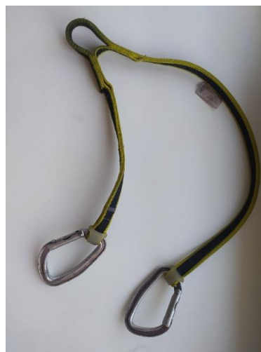
Рис.1. Система (бабочка) и «самка» (или страховочные усы - спелеостандарт)
