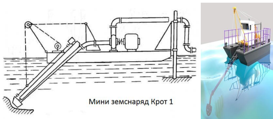
Рис. 1. Земснаряд «Крот» (схема и рис. натурального образца)
