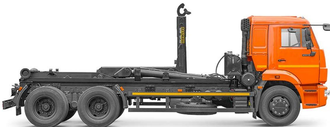
Рисунок 2 – Базовое шасси КАМАЗ 65115
