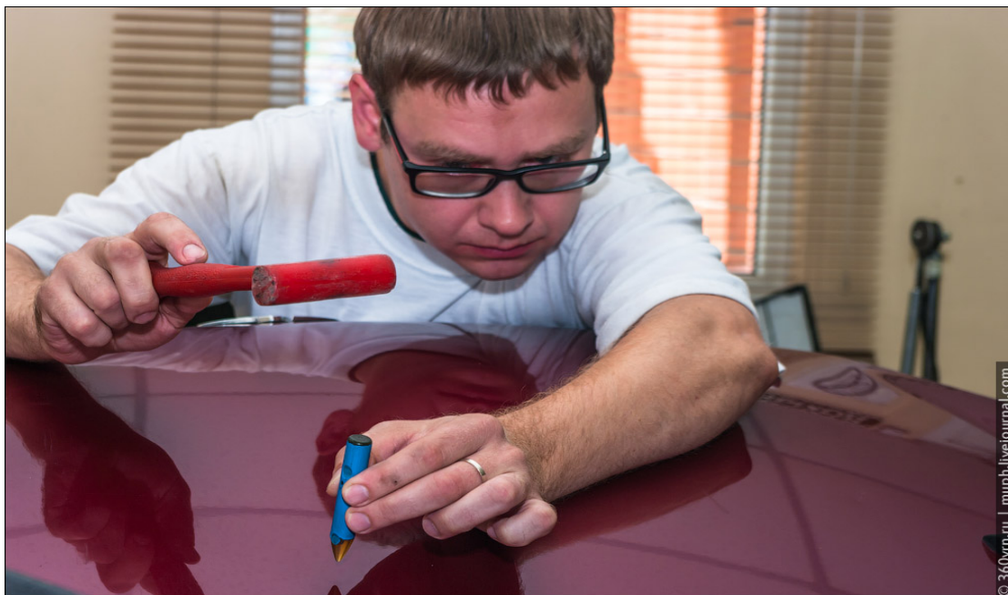
Рисунок 3.6- Операция по снятию напряжения металла с внешней стороны капота
