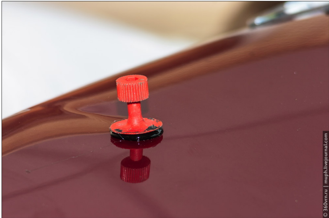
Рисунок 3.8 - Операция по выправления вмятины с помощью клея
