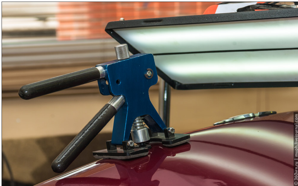
Рисунок 3.9- Операция вытягивания вмятины с помощью микролифтера
