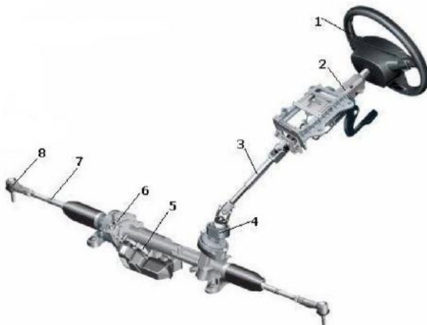
Рисунок 11 – Схема устройства рулевого механизма
