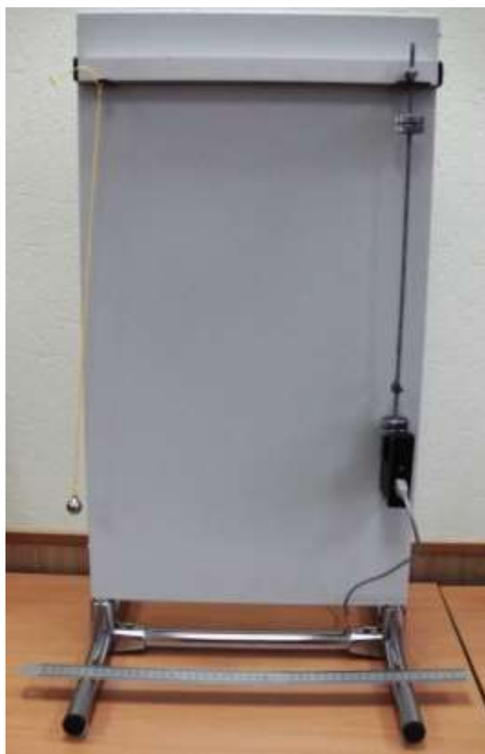
Рисунок 1 – Фотография установки лабораторной работы по определению ускорения свободного падения, реализованной в учебной лаборатории кафедры МЕН ИИПО РГППУ
