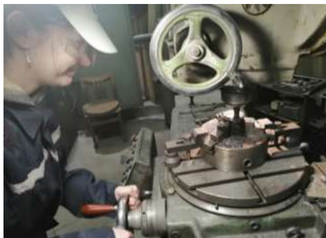
Рисунок 2 – Пробное выполнение трудовых приемов и способов фрезерования с использованием круглого поворотного стола
