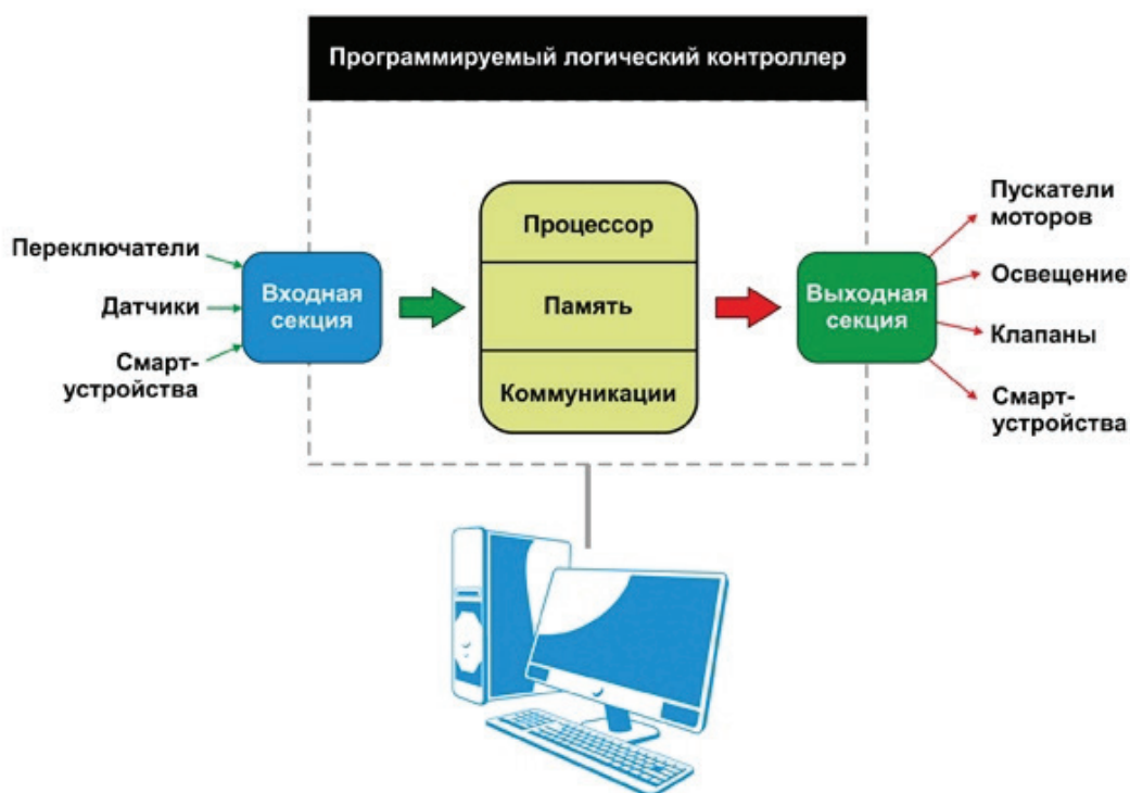
Рис. 1. Упрощенная архитектура программируемого логического контроллера
