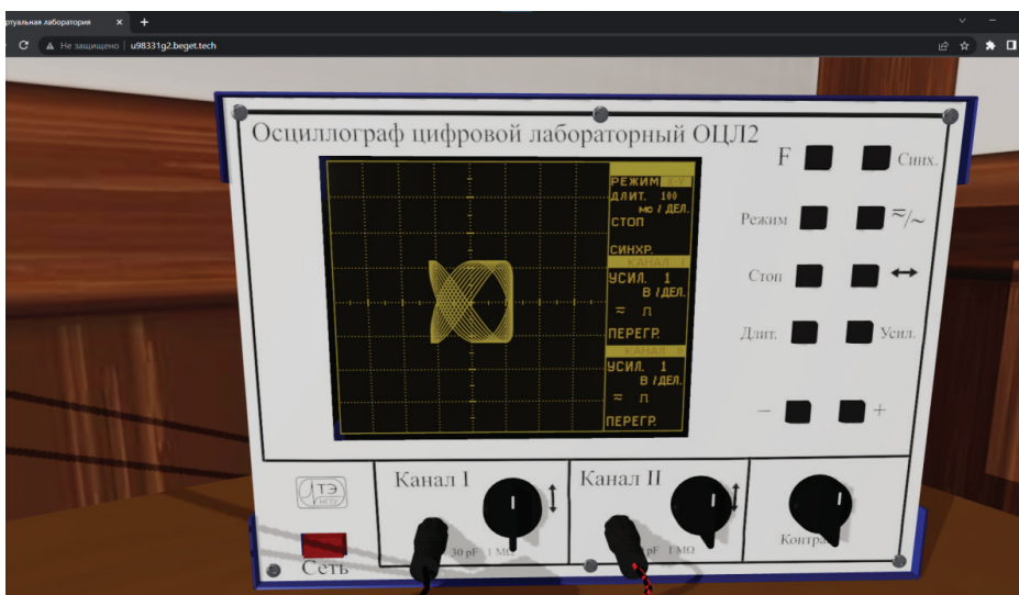
Рис. 3. Виртуальный осциллограф с осциллограммой фигуры Лиссажу (процесс настройки изображения на осциллографе)
