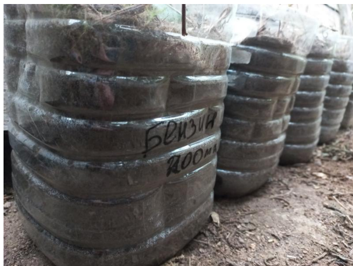
Рисунок 3. Подготовленная емкость для проведения лабораторного исследования на примере бензина.
